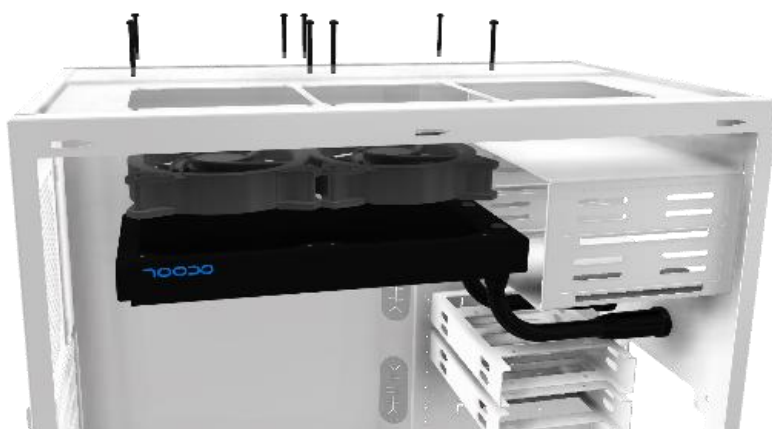
ventilateurs à suction
